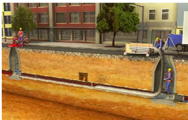
Figure 6 - Insertion de la gaine imprégnée
