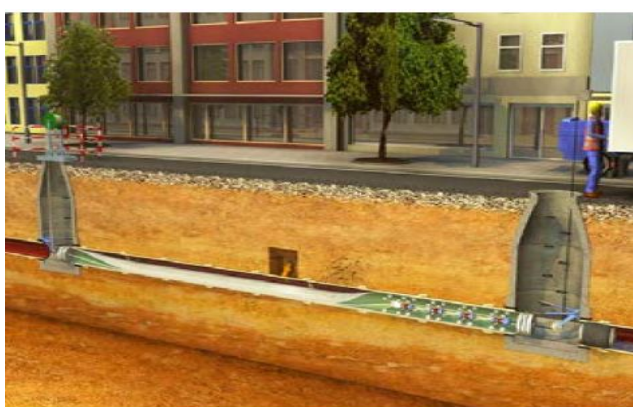
Figure 7 - Mise en pression de la gaine et passage du train UV
