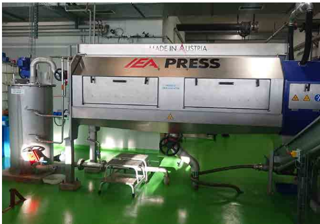
Nouvelle installation de déshydratation
