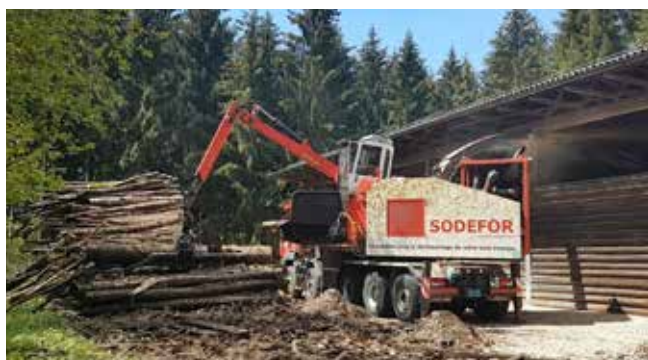
Travaux de déchetage
